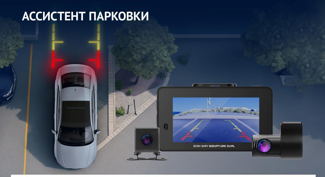
В **iCON WiFi Signature Dual** реализована возможность подключения второй камеры с функцией "Ассистент парковки". При включении задней скорости на дисплее отображается видео задней камеры с габаритными линиями парковки. Функция активна только при подключении второй камеры. Одновременная запись с 2-х камер обеспечивает полный контроль дорожной ситуации, делая вождение более безопасным.
