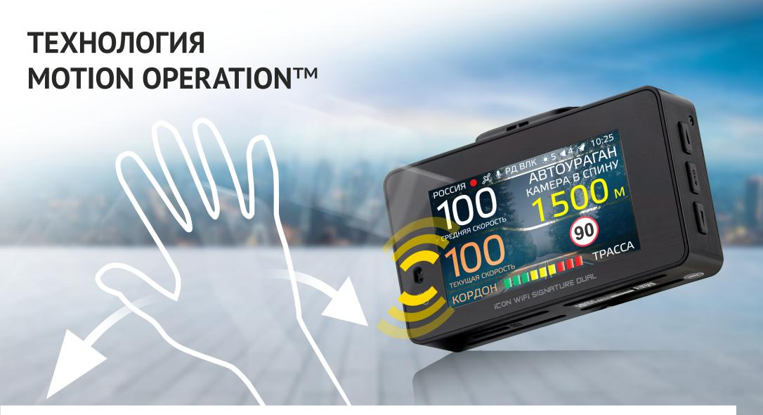
Фирменная технология Motion Operation™ позволяет одним движением руки отключить звуковое и голосовое предупреждения при приближении к радару или камере. Пользователю нужно лишь провести рукой перед экраном. Устройство отключит звук и включит только через 6 секунд после окончания оповещения.
